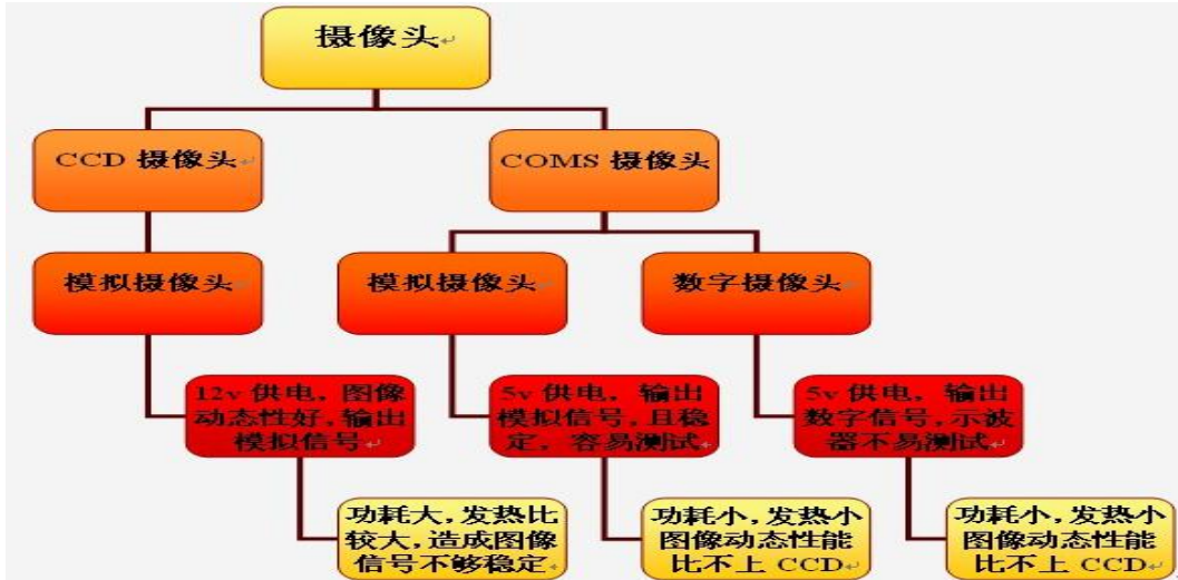
图 2.1 CCD 和 CMOS 摄像头的比较
